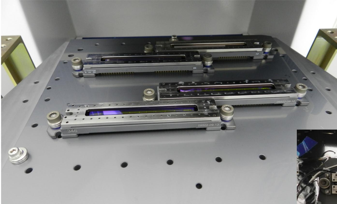
El Plano Focal de SEOSAT está fabricado en SiC para proporcionar una estabilidad termoelástica muy alta.
