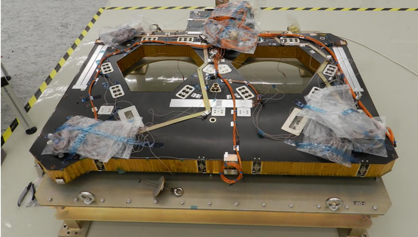
Las dos Cámaras de SEOSAT fueron instaladas sobre una estructura sándwich con piel de CFRP y núcleo de aluminio denominada HSSP.
